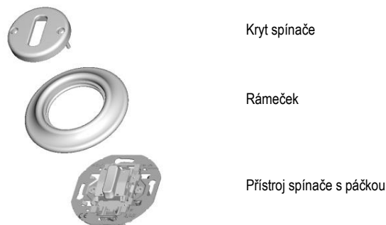
Obr. 1: Sestavování spínače s krytem a rámečkem
